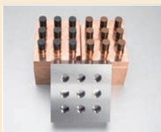
Obrábanie viacerých otvorov pomocou komplexnej elektródy
